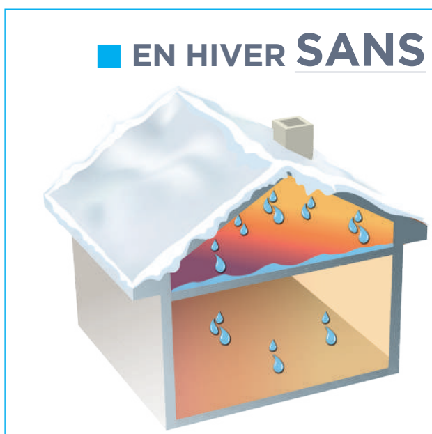
Accumulation de l'humidité
